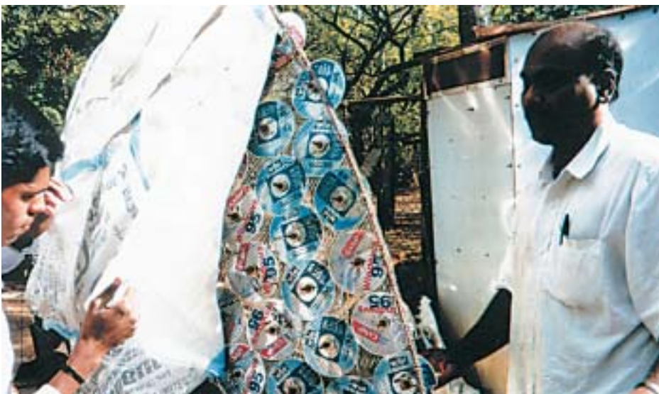
Sogar aus gebrauchten CD-Scheiben haben indische Solarkocher-Bastler schon den nötigen Parabolspiegel gefertigt! Der Wirkungsgrad ist hier geringer, aber ausreichend. Eher ein guter Gag, aber immerhin: Wegwerfmaterial wird genutzt.
